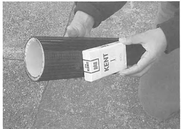
図2 耐波性イカダに使用したFRP製パイプ
