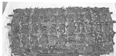
写真2-2 FRP炭化材-粗
