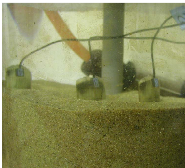
図21 開閉センサーの設置状況
