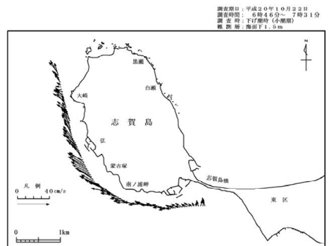
図6 小潮期の流向・流速水平分布図 （上段：上げ潮時、下段：下げ潮時）
