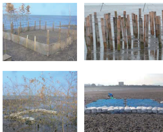
図1 干潟面に設置した各試験区の写真（上部右；砕石枠区、上部左；竹杭区、下部左；笹竹区、下部右；被覆網区）
