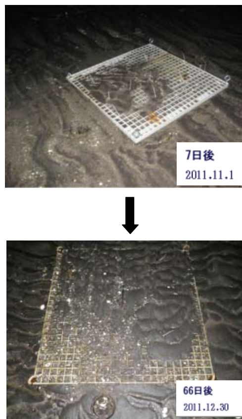
図9 試験区B（砂浜+グレーチング）
