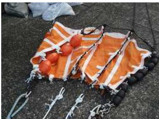
図1 小型底びき網用柔構造拡網装置
