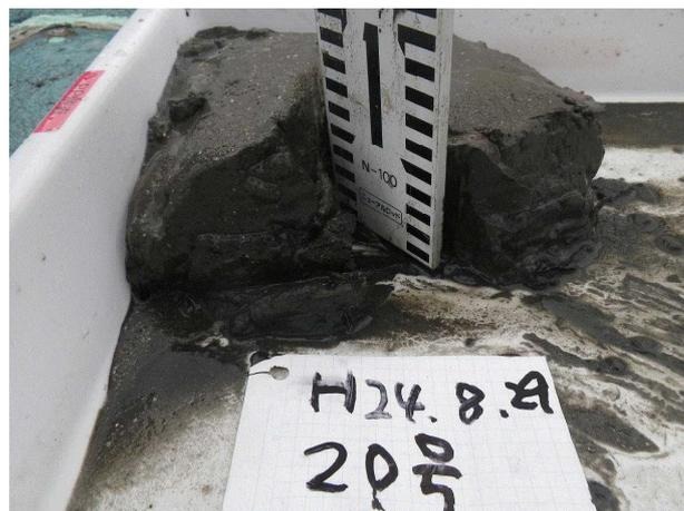
写真4 採泥器で採取した粘土質の泥
