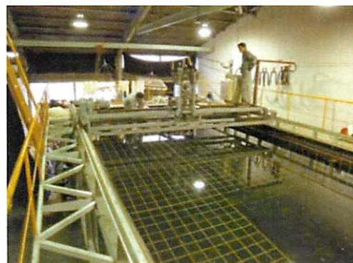
図3 まき網実験水槽（上面）
