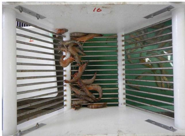
図6 作業後の通常魚体選別器内(スリット幅16mm)
