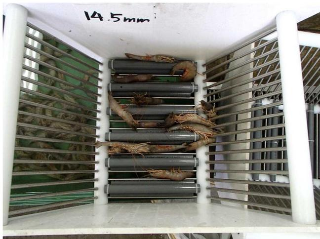
図7 作業後の改良した魚体選別器内 (14.5mm)
