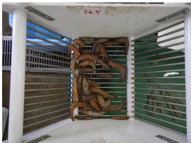
図5 作業後の通常魚体選別器内(スリット幅14.5mm)
