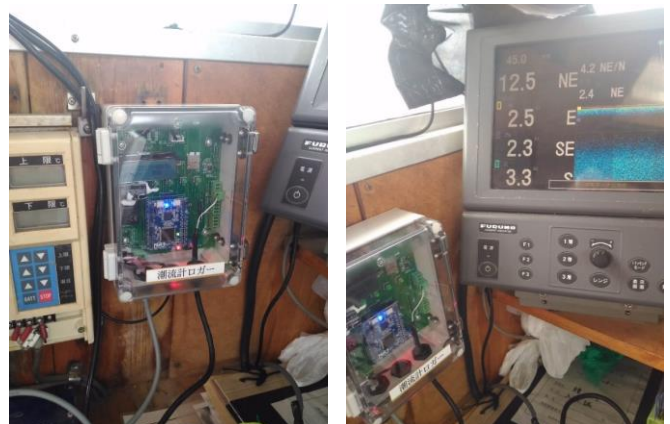
図1 先行テストの漁船に装着したロガー装置 (左) と潮流計 (右)
